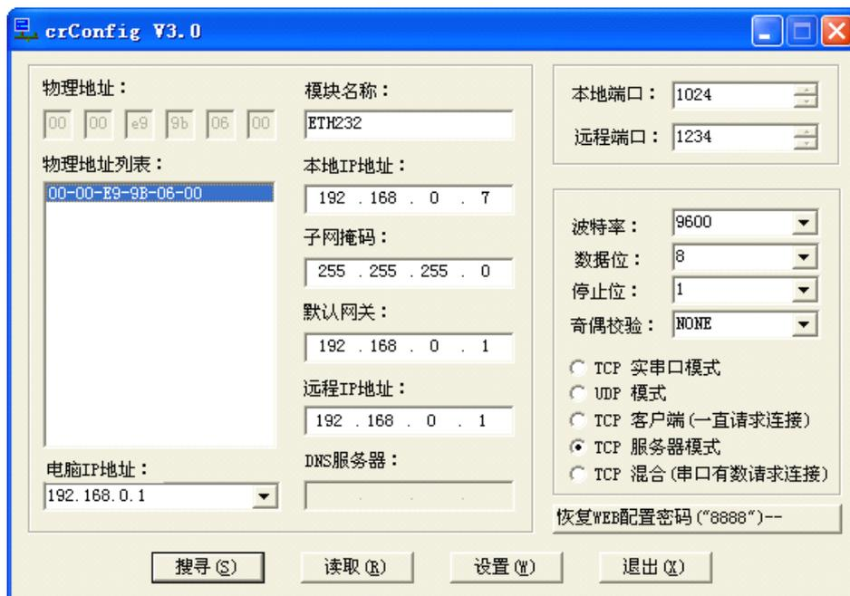
另外一台 ETH232 用作客户端【选“TCP 客户端（一直请求连接）”】，设置如下图。注意：1、“本地端口”和“远程端口”的地址与另外一台 ETH232 的设置正好相反。2、模式选“TCP 客户端（一直请求连接）”。3、“本地 IP 地址”必须与另外一台 ETH232 的 IP 地址最后一位不同，前 3 位必须一样。4、最重要的是“远程 IP 地址”必须设置为另外一台 ETH232 的“本地 IP 地址”。
