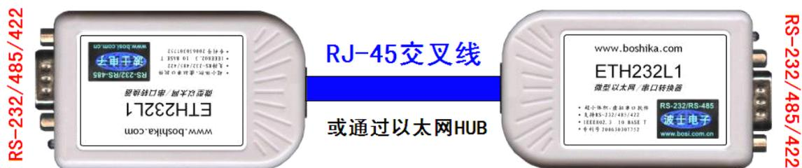
注意两台 ETH232 如上直接对连时，必须使用交叉线。两台 ETH232 也通过以太网 HUB 来连接，这时使用交叉线或直连线都可以，注意两台 ETH232 分配的 IP 地址必须互相能够 PING 通，这样保证以太网通讯线路没有问题。用 ETH232 进行 RS-232 通信时只要接 RXD/TXD/GND 三根线，其余线不要接，进行 RS-485/422 通信时建议要接 GND 地线。
