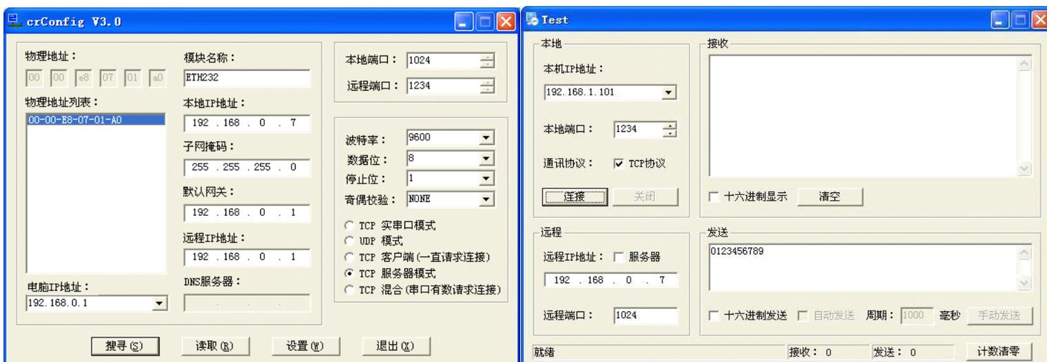
通过 Config 设置后 ETH232GH 产品可以脱离计算机。此时向 ETH232GH 的以太网口(RJ-45 口)传送的 TCP/IP 协议数据将自动转换为串口的 RS-232 协议数据。同样此时向串口传送的 RS-232 协议数据将自动转换为 ETH232GH 以太网口 (RJ-45 口) 的 TCP/IP 协议数据。只要原来可以通过以太网访问本产品所设置的以太网 IP 地址，那么也就可以通过以太网读写连接在本产品的串口上的设备数据了。
