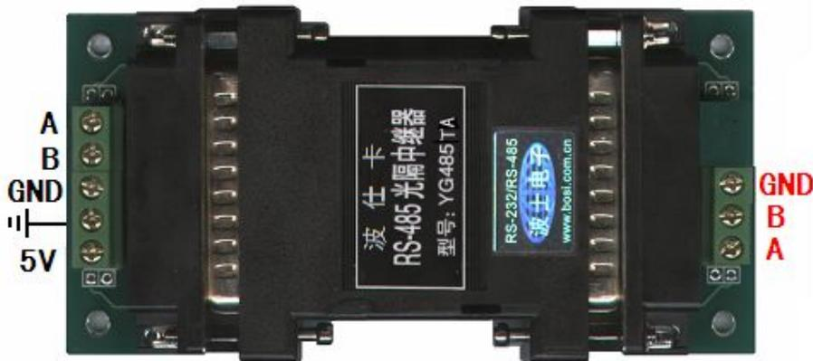
YG485TA 的两端均为 DB-25 针座, 并且配有接线端子。YG485TA 对外接的+5V 电源没有严格要求(电压 4.5~5.5V, 功耗电流<100mA)。建议选用波仕电子的微型开关稳压电源(输入交流 220V, 输出隔离直流 5V 100mA, 仅重 35 克, 插头大小)。
