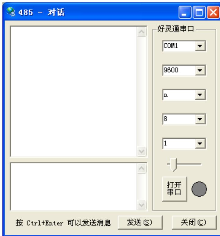
“好灵通串行口”部分的 COM 口号就是本计算机插的 USB232HLT 的 COM 口号。双击好友头像出现上面的对话界面可以发送数据（聊天）和进行串口通信、点击鼠标右键可选“传输文件”来进行文件传输。haolingtong5 的串口通信只能够在两个好友之间进行、不支持广播功能。串口数据不会发送给自己，以符合 RS-232/RS-485 多机通信规则。
