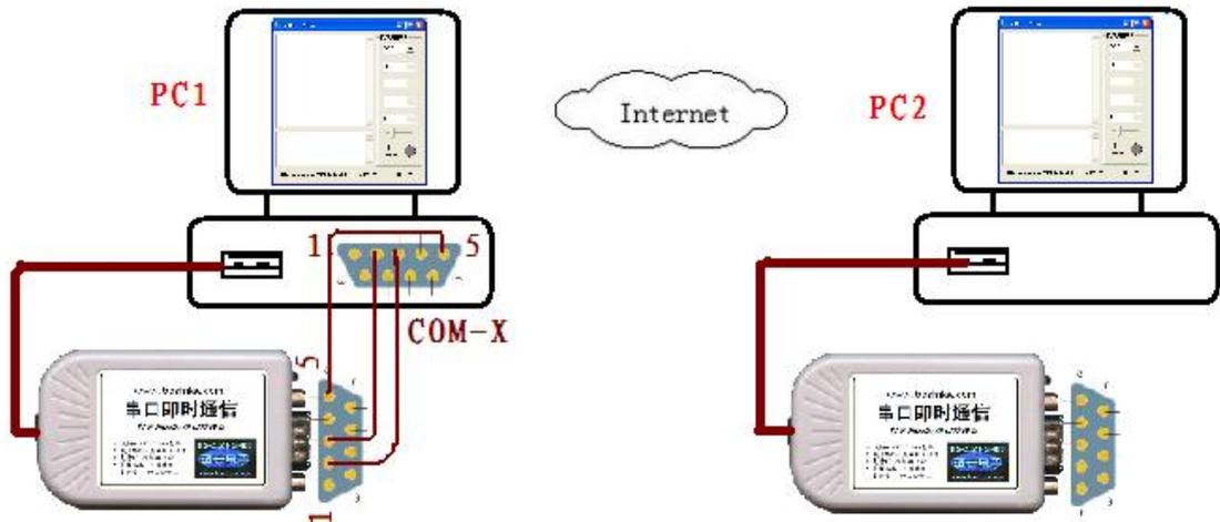
注意要将本地计算机自己的串口 COM-X 与本地计算机接的 USB232HLT 的串口要连接起来。如果是使用 RS-485，则 A 接 A，B 接 B、GND 接 GND。如果是使用 RS-232 口，注意 RXD-TXD 收发线交叉，GND-GND 地接地。注意本产品只支持只有 RXD、TXD、GND 的 3 线 RS-232 通信，不支持有握手信号的 RS-232 通信。
