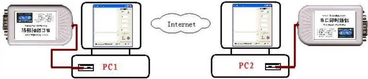
只要 PC1 与 PC2 之间是通过好灵通软件连接的，那么它们所接的 USB232HLT 之间是完全透明的。显然两台计算机的即时通信软件即使各自设置成为不同速率等也是可以通信的，也就是说还可以实现不同速率之间的串口透明传输。这是一般的串口远程通信无法实现的功能。
