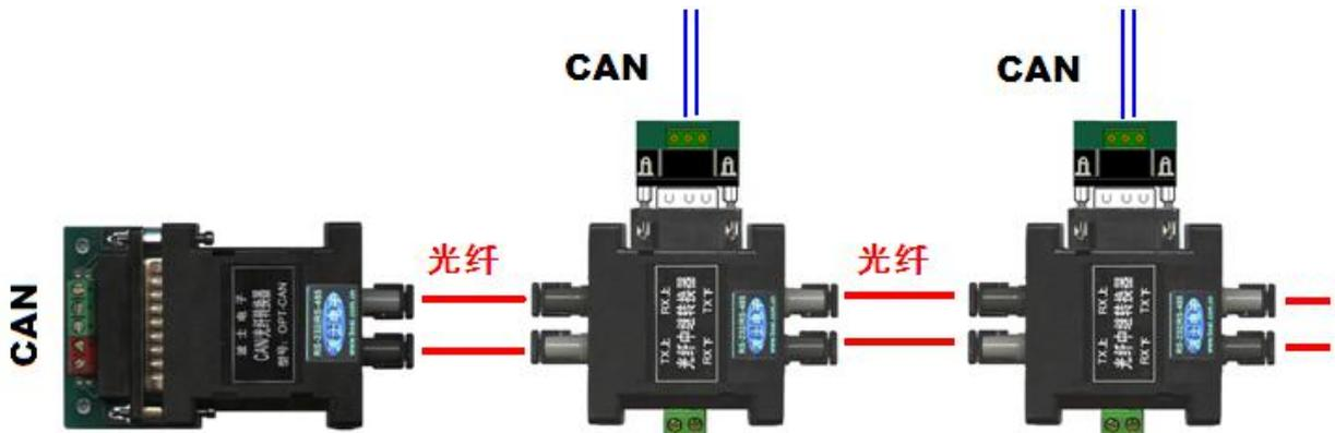
本产品可以与波仕 OPT-CAN[S]系列产品配合使用实现 CAN 光纤远程多机通信。注意产品分单模和多模 2 种：单模转换器与单模中继器产品配合。多模转换器与多模中继器配合。
