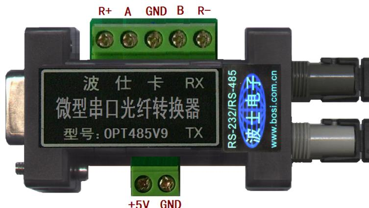
波仕电子配套提供各种长度单芯、双芯光纤以及 ST、FC、SC 接头。注意 RS-232、RS-485/422 不要同时使用。OPT485V9 产品自带有 5V 电源（4.5 V 到 5.5V），产品功耗小于 100mA。
