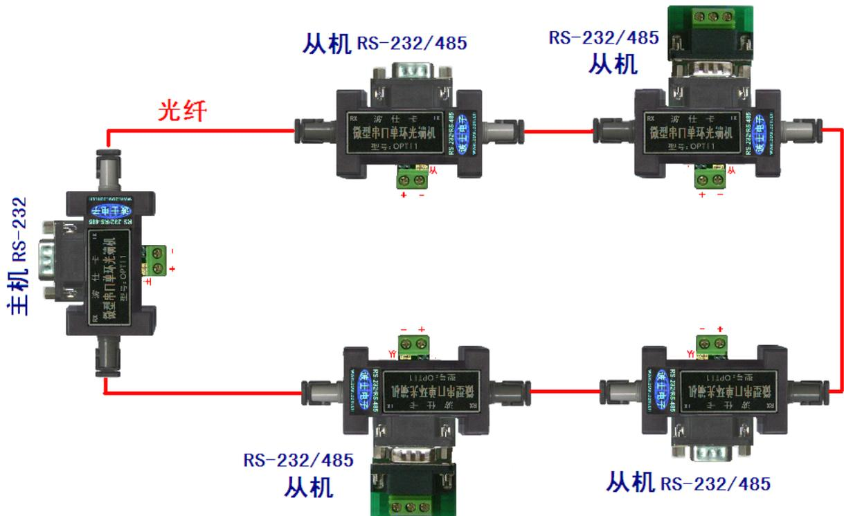
在整个光纤环路中，只允许一个 OPT11[S]设置为主机（跳线到“主”的位置，靠近“+5V”侧），其余 OPT11[S]全部设置为从机（跳线到“从”的位置，靠近“GND”侧）。从机的数量不受限制。软件同 RS-485 总线式多机通信。
