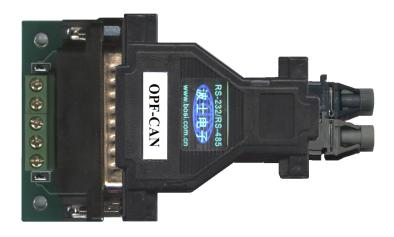
波仕电子配套提供各种长度塑料光纤以及接头。OPF-CAN 对外接 5V 电源要求  $5V(\pm 0.5V)$  ,产品功耗小于 100mA,产品配套有微型开关稳压电源。
