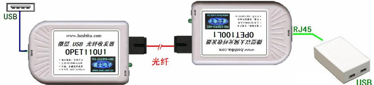
图 3：使用单纤的 OPET-USB21 全套产品
