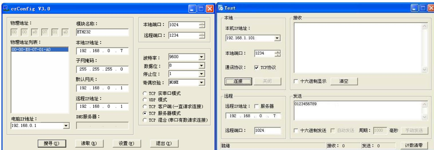
通过 Config 设置后 OPET232L1 产品可以脱离计算机。此时向 OPET232L1 的以太网口 (RJ-45 口) 传送的 TCP/IP 协议数据将自动转换为串口的 RS-232 协议数据。同样此时向串口传送的 RS-232 协议数据将自动转换为 OPET232L1 以太网口 (RJ-45 口) 的 TCP/IP 协议数据。只要原来可以通过 INTERNET 访问本产品所设置的以太网 IP 地址, 那么也就可以通过 INTERNET 读写连接在本产品的串口上的设备数据了。
