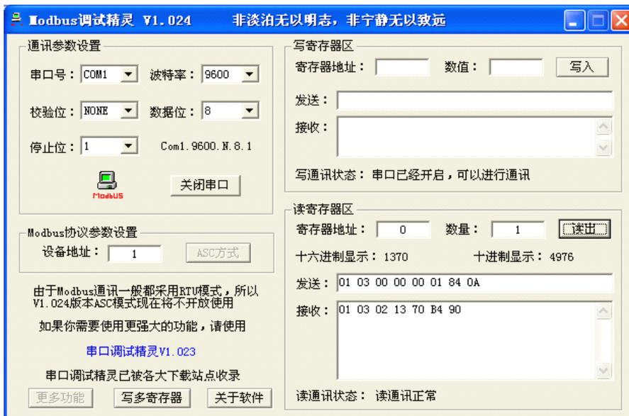
按“读出”，如图就可以看到“十六进制显示：”（1370）和“十进制显示：”（4976）的测量结果，单位为 mV。由于 MOD4205 的电流环测量端子上反面有 250 欧姆的采样电阻，所以电流环的测量结果为 250 欧姆采样电阻上的电压值。如果用户要求全部测电流环或者全部测电压，可以焊上或者取下对应通道的采样电阻。
