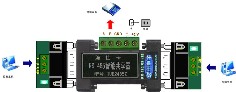
新的 HUB2485Z 的两个接线端子上分别有绿色 LED 指示灯用来表示两个上位机的允许通信状态。左边 LED 绿灯亮表示左边的上位机 RS-485 允许通信，左边 LED 绿灯灭表示禁止左边的上位机通信。右边 LED 绿灯亮表示右边的上位机 RS-485 允许通信，右边 LED 绿灯灭表示禁止右边的上位机通信。LED 绿灯一直亮着表明该上位机通道畅通，绿灯灭表示禁止，闪烁就表示间断允许和间断禁止。刚开始时两个 LED 绿灯都是亮的，如果其中一个上位机 1 开始发送数据则另外一边的上位机 2 的绿灯会暂时熄灭直至上位机 1 数据发送完毕。
