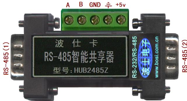
HUB2485Z 的外型为 DB-9（针）/DB-9（针）转接盒大小，其中 DB-9 针的 RS-485 的引脚分配同波仕 485A 型号的转换器并且配接线端子。两个 DB-9 针的上位机 RS-485 口，如图 RS-485（1）和 RS-485(2)是完全一样的，可以互换。下位机 RS-485 为接线端子，位于如图产品的上侧面，与电源接线端子在一起。HUB2485Z 需要外接 5V 电源，配套提供。
