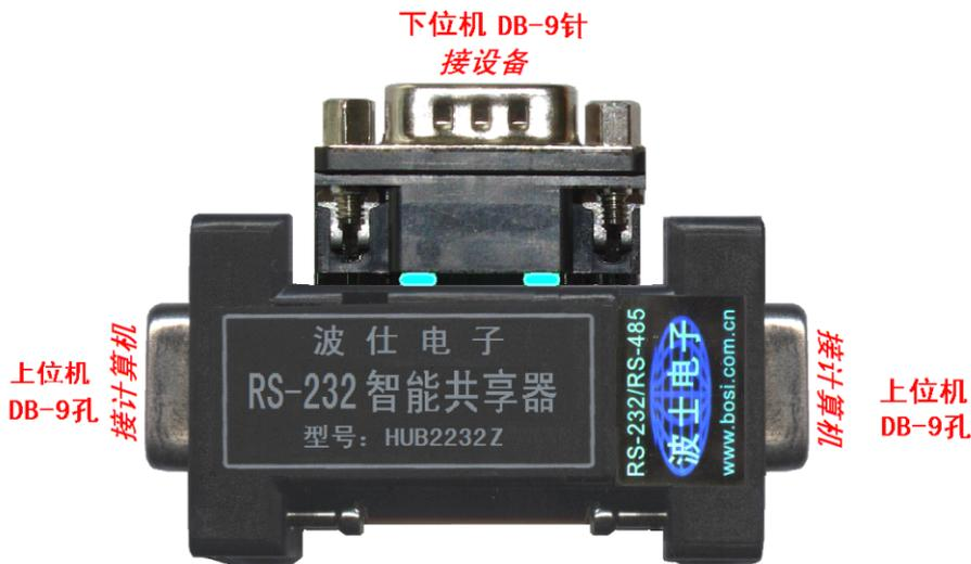
HUB2232Z 的外型为 DB-9（孔）/DB-9（孔）转接盒大小，其中两个 DB-9 孔可以直接插在 PC 机的 DB-9 针座 RS-232 串行口上，中间一个 DB-9 针的引脚分配同计算机的 RS-232 口，但是只有 RXD、TXD、GND 三线。HUB2232Z 无须外接电源！
