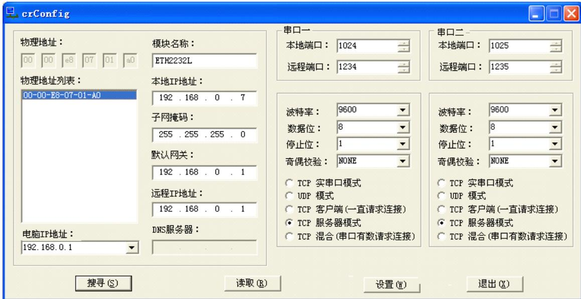
串口 1 与串口 2 的 IP 地址相同，为 192.168.0.7，均设置为“TCP 服务器模式”，“本地端口”分别为 1024（串口 1）和 1025（串口 2）。相应的，在 Test.exe 程序界面中，串口 1 的“远程端口”填 1024，串口 2 的“远程端口”填 1025，“远程 IP 地址”均为 192.168.0.7，波特率默认 9600。
