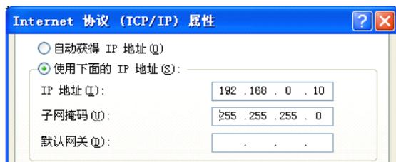
如果 ETH2232L 已经正确连入计算机以太网口，那么从 **config200.exe** 的“设备状态”窗口可见到设备的 IP 地址和 MAC 地址。根据用户使用的网络环境改变网络参数而加入网络。这些网络参数包括 IP 地址，网关 IP 和网络掩码。用户可以直接使用 **test.exe**（带源程序）进行串口的通信，把以太网中的 ETH2232L 系列产品当作串口来通信，也可以将 **test.exe** 的源代码嵌入用户的应用程序中。在随产品赠送的光盘中有如何通过操作 ETH2232L 的 IP 地址读写来实现串口数据的发送和接收的 VC、VB、BC、DELPHI 源程序，所有源代码仅供专业人士参考。特别注意 **config200.exe** 设置中的本地端口地址和远程端口地址与 **test.exe** 中的要一致。连接通了以后可以修改 ETH2232L 的 IP 地址和用户的服务器的 IP 地址，但是也是前 3 位必须一样。最后一位 0-255 均可，但是不要与 ETH2232L 的一样。
