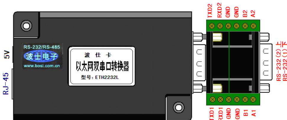
波仕ETH2232L型以太网/双串口转换器将以太网信号转换为2路独立地址RS-232/RS-485, 设置软件兼容波仕的ETH232系列以太网/串口转换器。它具有超小型的外形(80\*25\*55mm), 可以虚拟成为本地串口, 支持串口透明传输、并且带设置软件。ETH2232L是波仕全新一代产品。支持100/10M以太网, 自适应RJ-45直连线交叉线, 5V供电, 内部1000V变压器电气隔离。波仕ETH2232L是世界上最小的、也是使用最简便的以太网/双串口转换器。波仕新一代专利产品, 谨防假冒! 专利号: 201120297328, 200630307752。
