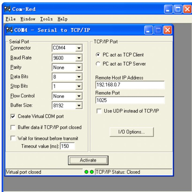
由于 ETH2232L 有 2 个串口，所以需要运行 Com\_Red 两次。每次虚拟一个串口。两次软件设置界面不同的地方在于 Connector 的 COM 口的号码以及 Remote Port 地址（图中 1025）。；如果 ETH2232L 的 Config 设置为“TCP 客户端（一直请求连接）”，那么“远程 IP”必须填写计算机的以太网网卡的 IP 地址。此时 Com-Red 界面选“PC act as TCP Server”，IP Address 填写计算机的以太网网卡的 IP 地址，Port 填 ETH2232L 的远程端口（比如分别为 1234 代表串口一和 1235 代表串口二）。
