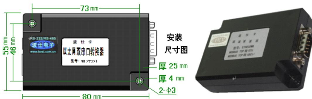
ETH2232L 的 RS-232/485 的最高通信速率为 115.2Kbps。波仕 ETH2232L 内部带 1000V 变压器电气隔离，并且内置有 600W 抗雷击浪涌保护器。
