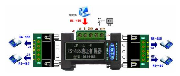
DIZ4485 的外型为 DB-9(针)/DB-9(针)转接盒大小,两端完全一样。产品中间的侧面分别为 RS-485 口和 5V 电源(接线端子),如图。DIZ4485 需要外接 5V 电源。DIZ4485 的两头 DB-9 针端均配套有各带接线端子的板,共 4 组 RS-485;4 个下位机 RS-485 口(0#,1#,2#,3#),在相应的位置带指示灯。使用之前通过发送地址指令来分时选通四个下位机 RS-485 口,选通某个口后端子板上对应位置的灯会亮。选择下位机串口地址只需要加一句指令,刚加电时默认所有口全部断开,同时所有灯灭。软件选通某个口后,相应的灯会亮起。支持通信速率 0-115.2Kbps,自动适应。随产品配套有一个 5V 稳压电源。J0、J1 跳线用来选择地址设置指令,一般情况下将跳线 J0、J1 断开即可,超过 4 个口才需要设置跳线。
