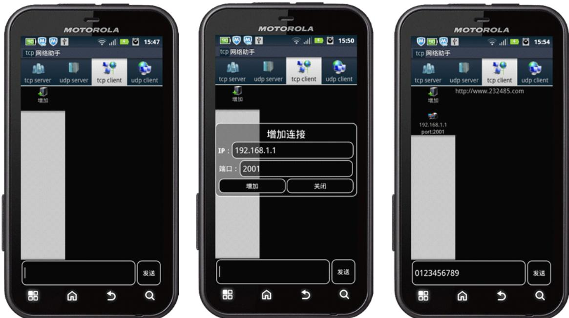
现在就可以与 AP232L 的串口进行通信了。成功连接后，可以在发送区输入你要发送的数据或字符。这些数据将以透明模式转换到 AP232L 的串口发送出来。如果这时 AP232L 连接到某个计算机的串口，就可以用串口调试助手软件监测到并显示这些数据，注意设置的网络串口的波特率。同样 AP232L 的串口数据将透明传输到 TCP 网络助手的界面中，并在接收区显示。
