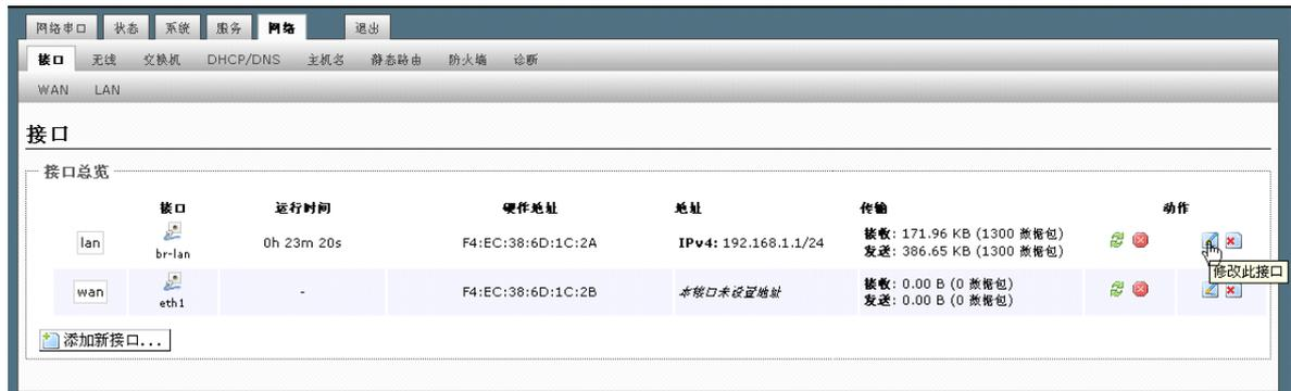
修改 IP 地址后，用户必须记住新的 IP 地址，否则只能通过硬件复位到 192.168.1.1。通电状态下将 AP232L 的 RESET 键一直按住 5~10 秒可以复位。复位后串口波特率为 115200。
