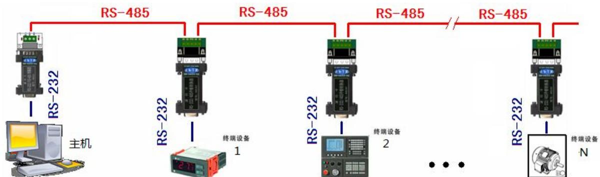
485A2 应用与 RS-485 多机通信的典型接线图。若每一段 RS-485 的距离为 1200 米和 128 个,则整个 RS-485 系统的距离达到  $(N \times 1200 \text{ 米})$ 、节点数达到  $(N \times 128)$ 。可以看出,使用了 485A2 的 RS-485 总线布线极其简洁。最远两端可以用 485A,也可以用 485A2。注意整个 RS-485 系统共用 GND 线。
